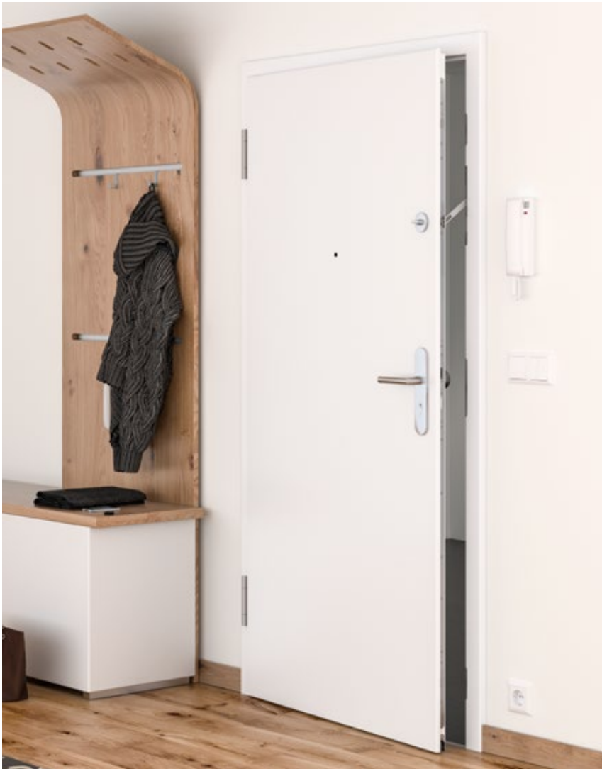
KÖ-PRBILD-00100 | Wohnungseingangstür, Weißlack, Überschlagdichtung, Weitwinkelspion, Drei-Bolzen-Sicherheitsschloss mit Sperrbügel, Zarge KÖNOSOFT, Sicherheitsgarnitur Madrid, Langschild Rundform, Edelstahl
